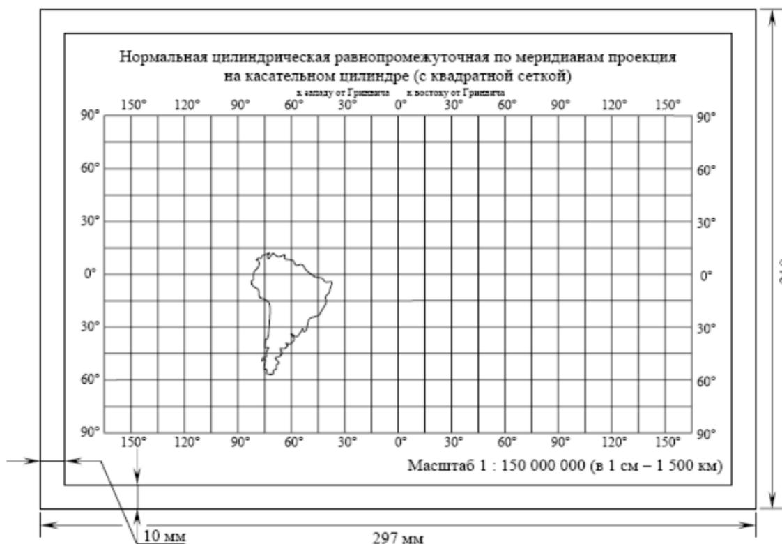
Рис. 7. Макет картографической сетки нормальных цилиндрических проекций с указанием необходимых размеров в оформлении рамки
