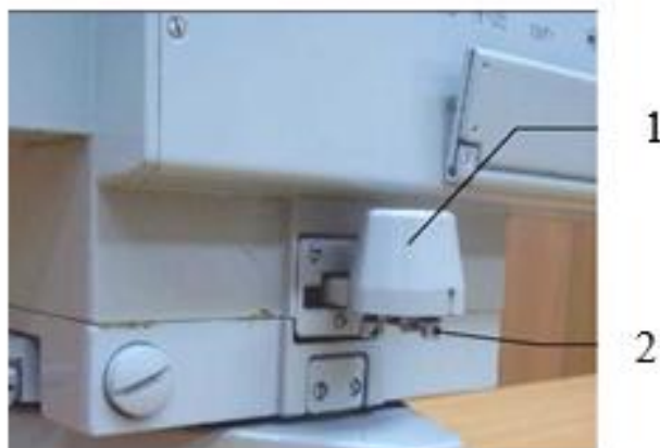
Рисунок 6.7 - Регулировка установочного уровня:
