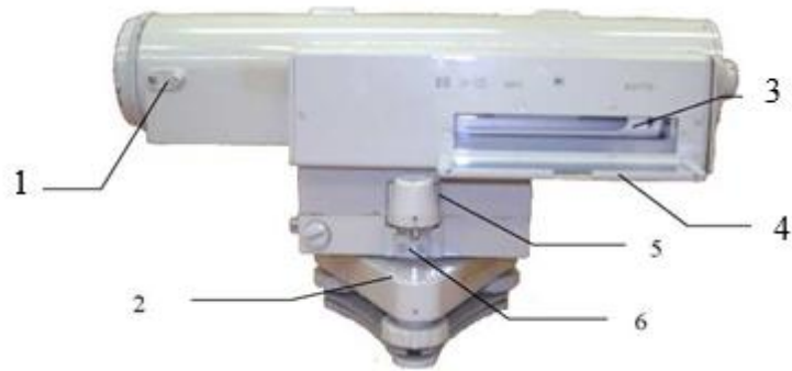
Рисунок 6.4 - Нивелир Н-05 (вид со стороны цилиндрического уровня):
