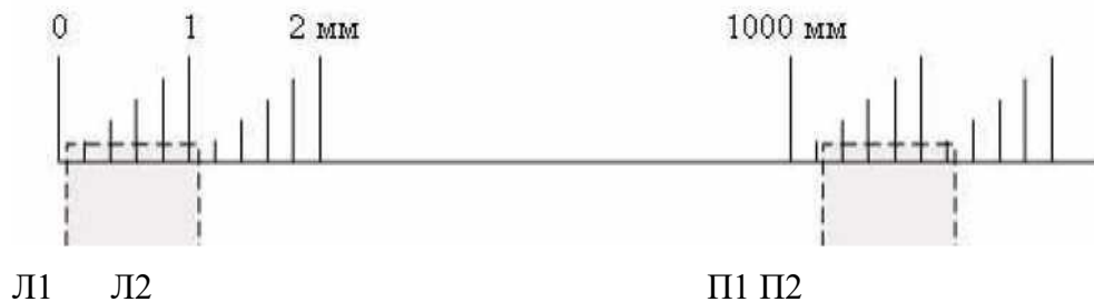
Рисунок 7.5 - Определение погрешности метровых интервалов с помощью нормальной линейки:
