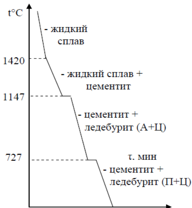
Рисунок 3 Кривая охлаждения сплава с содержанием углерода 3%
